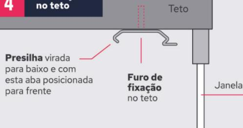
Se a persiana for instalada no teto, fixe as presilhas com as abas posicionadas como no exemplo da imagem acima. Neste caso, a utilização dos suportes L torna-se desnecessário.
