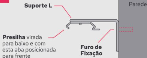
Fixe os suportes que acompanham o kit do bandô na parede com as presilhas viradas para baixo. Se o produto for instalado no teto, utilize apenas as presilhas, pois o suporte L torna-se desnecessário.
