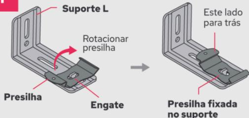
Fixe as presilhas nos suportes L encaixando o furo da presilha no engate do suporte e rotacionando até ficarem devidamente presas. Siga o exemplo da imagem acima como referência.
