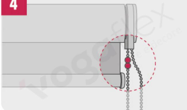
Para um ajuste de regulagem de altura mais fino, utilize a bola limitadora. Retire e coloque novamente a bola até chegar no ajuste desejado. A bola limitadora não deve ser regulada num tamanho maior do que a altura da sua persiana.
